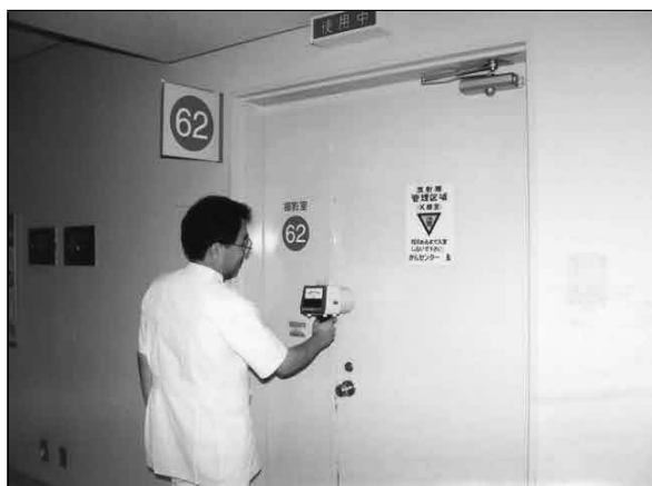
写真1. エックス線診療室の漏えい線量測定
