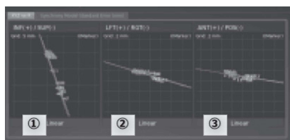
図5 LED-腫瘍相関モデル 図5は横軸がLEDマーカーの動きであり、縦軸が腫瘍の動きである。①はSI方向②はLR方向③はAP方向の相関を示している。
