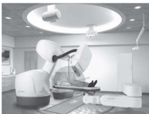
図3 サイバーナイフによる多方向照射
