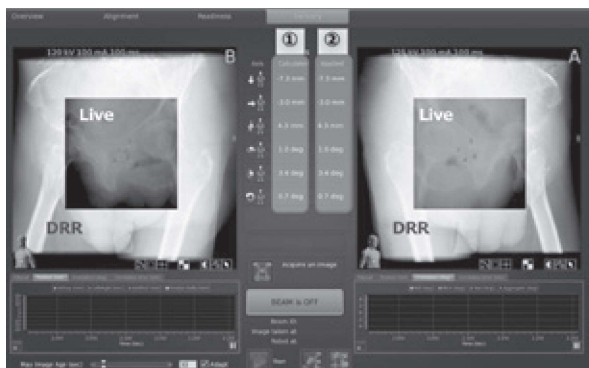
図2 位置確認装置 青色がLive画像、白色がDRR画像 ①計算された位置ずれ②ロボットに反映される移動量
