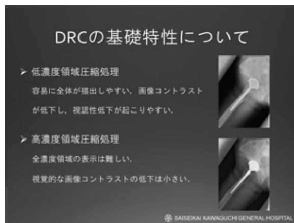
図 17 DRC 処理の特性
