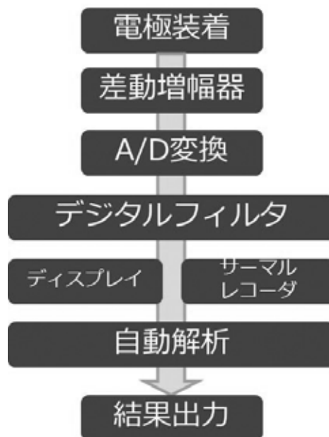
図2. 心電計のフロー
