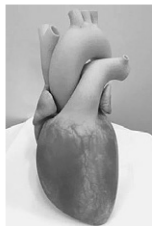
図6. STRATASYS 社製新型 3D プリンタ「J750」による心臓モデルサンプル
