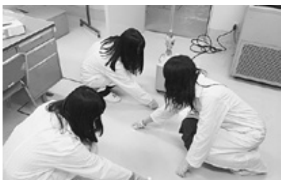
図7. スメアろ紙を用いた床の RI 汚染に対する間接測定法の実施
