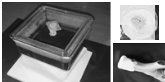
図1. 霧箱と線源2種類 (右上段：マンツルの芯、右下段：掃除機でラドン壊変生成物を捕集している様子)
