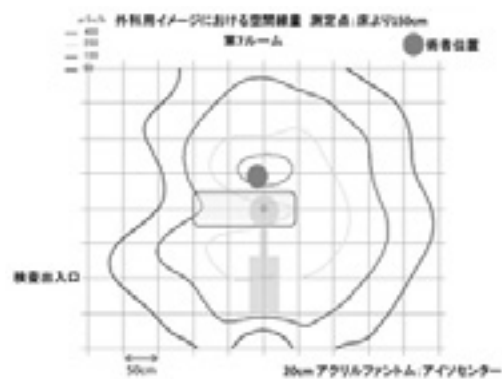
図2. 室内散乱線量分布図
