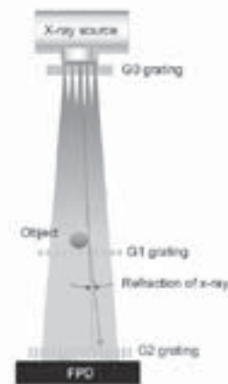
図3：X線 Talbot-Lau 干渉計撮影装置の概念図
