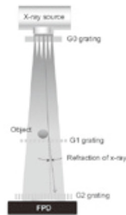
図3：X線 Talbot-Lau 干渉計撮影装置の概念図
