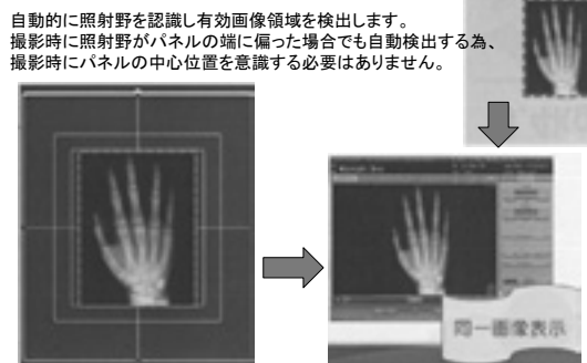
図 4：自動照射野認識機能
