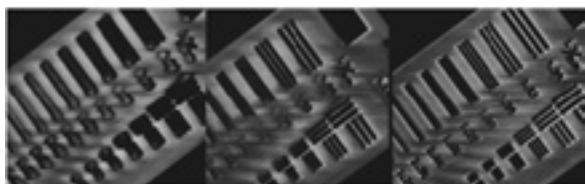
図 14：各視野サイズによる分解能（3D-RA） FPD：48cm（左） FPD：27cm（中央） FPD：15cm（右）
