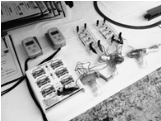
写真5：手回し発電機によって電気を起こし、LED電球と豆電球の比較をする装置など
