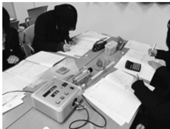
写真8：鉛による \gamma 線の吸収実験の様子 (高校のための放射線実習セミナー)
