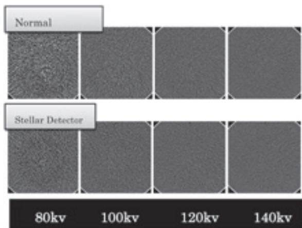
図10：30mAs一定で管電圧の変化に伴う画像SDの変化
