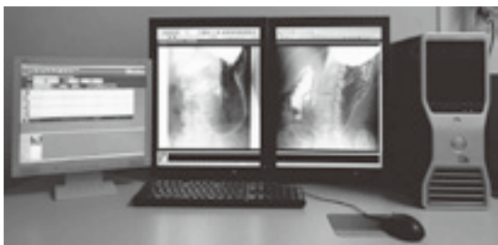
図2：(株)ドクターネット読影システム 3Mモニター2台と1Mモニター1台にて読影 経過観察症例については、過去画像と対比し観察する。
